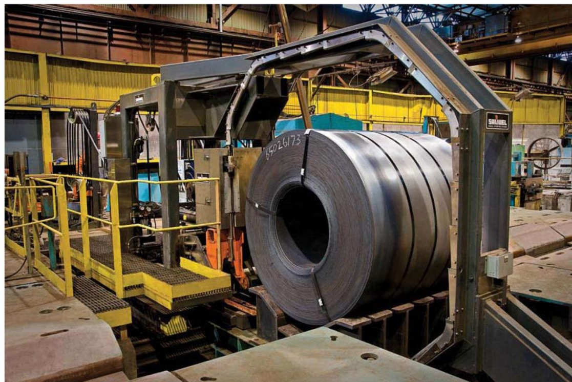
Máquina de cintamento circunferencial de alta velocidade com cabeçote duplo para bobinas aquecidas a 426°C
